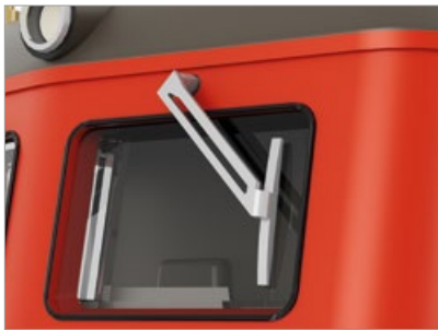
■ Feine Scheibenwischer als Ätzteil
