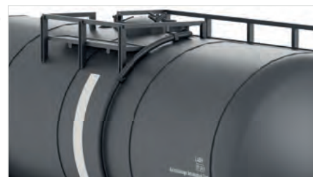
Extra angesetzte Leitung für Chemiekessel
