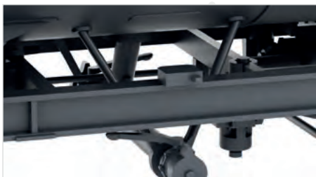
Entladeeinrichtung mit diagonaler Befestigung
