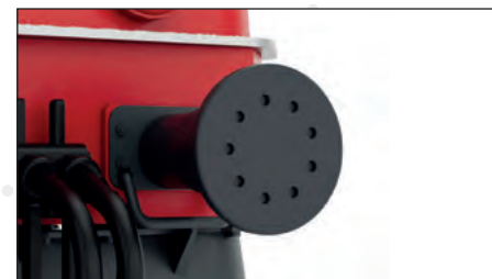
Runde Pufferausführung für Crossrail
