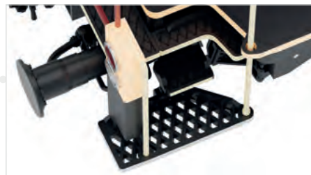
Durchbrochen dargestellte Trittstufen
