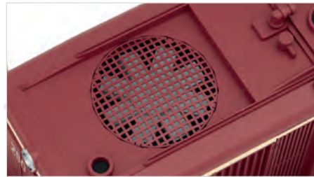
Abdeckung über dem separat angesetzten Lüfterrad als zierliches Ätzteil umgesetzt
