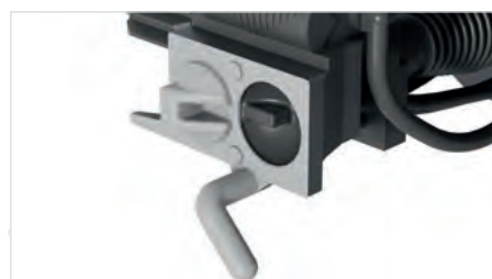
Scharfenberg Kupplung detailreich umgesetzt
