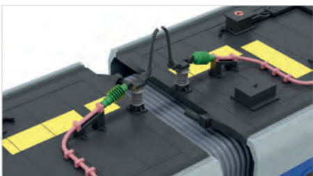
Mehrteilige und farblich abgesetzte Dachausrüstung
