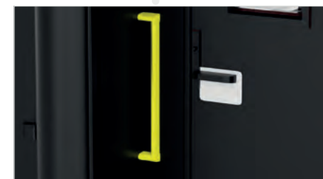
Freistehende Griffstange am Endwagen
