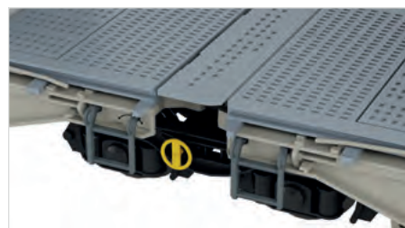
Mehrteilige Umsetzung der Be- und Entladebühne für den Anlagenbetrieb
