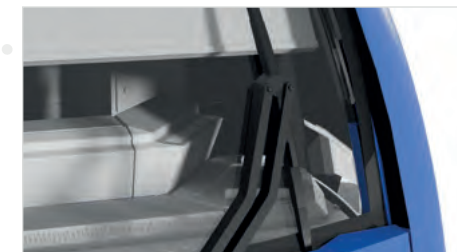
Frontblende, Scheibenwischer und Sonnenrollo separat angesetzt
