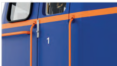
Je nach Ausführung verschieden positionierte Türgriffe
