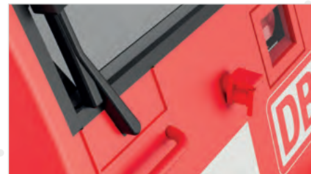
Freistehende Griffstangen und UIC-Dosen an der Lokfront
